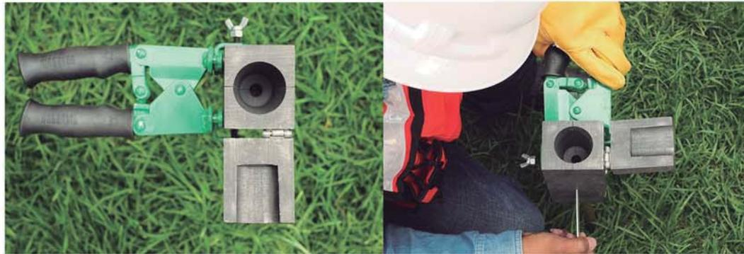
Coloque los conductores o elementos a soldar limpios
