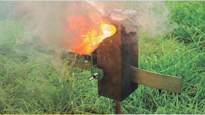
Moldes Conduweld: Moldes 100% de grafito, utilizados para realizar soldaduras exotérmicas, y hace posible la unión entre diferentes calibres y materiales.
